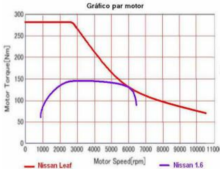
ILUSTRACIÓN 2.18 – PAR MOTOR NISSAN LEAF Y 1.6 [20]
