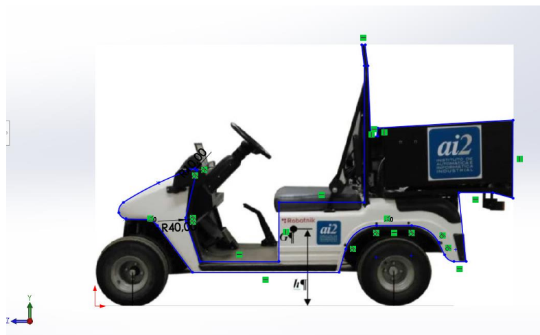
ILUSTRACIÓN 3.5 – IMAGEN DE CROQUIS DEL VEHÍCULO RBK EN SOLIDWORKS
