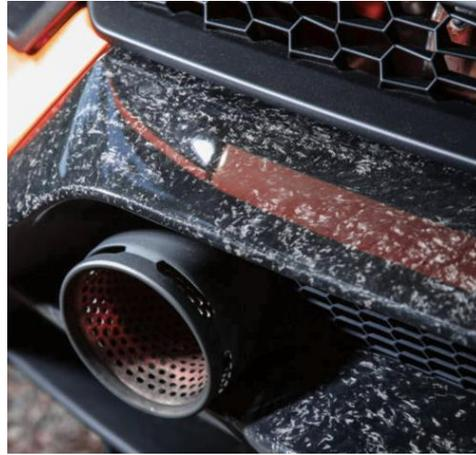
*Ilustración 20: Fibra de carbono forjada.*
