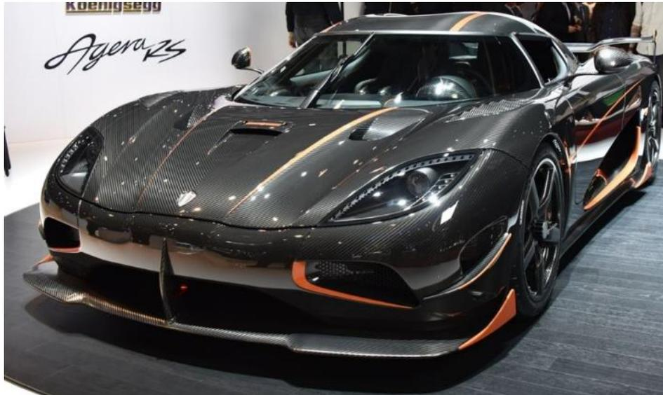
*Ilustración 22: Vehículo Fabricado con Fibra de carbono. Koenigsegg Agera RS.*
