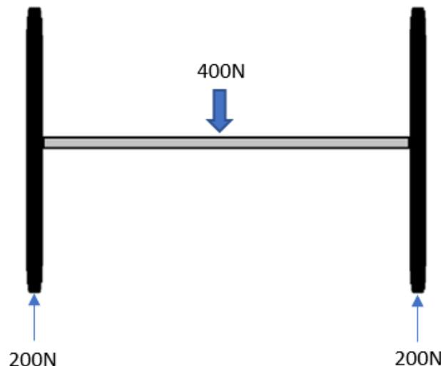
Ilustración 28: Esquema Fuerzas eje delantero.
