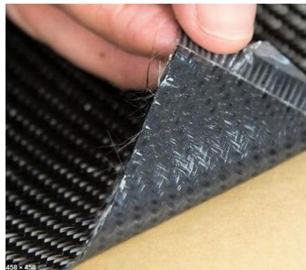
*Ilustración 25: Ejemplo fibra de carbono Prepreg.*
