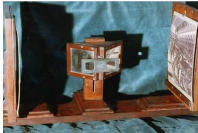
**Figura 2.3:** Estereoscopio de Wheatstone, basado en espejos (1838)
