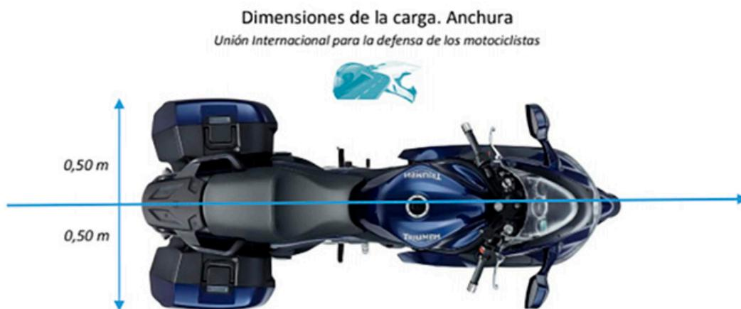
Ilustración 14 - Aclaración medidas máximas de carga.
