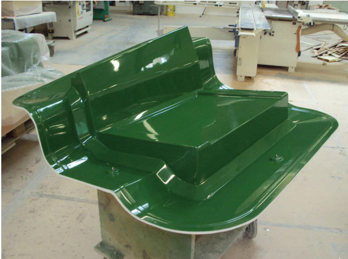
Ilustración 88 - Molde abierto de infusión.
