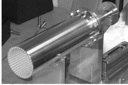
**Figura 4.3:** Ejemplo de bocinas con metamateriales en las paredes laterales propuesto por Sotoudeh [129].
