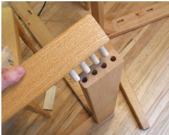
Ilustración 46: Unión mediante espiga
