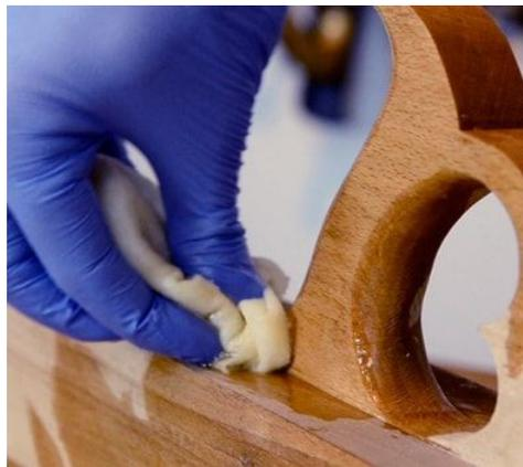
*Ilustración 39: Aplicación capa de aceite de tung*
