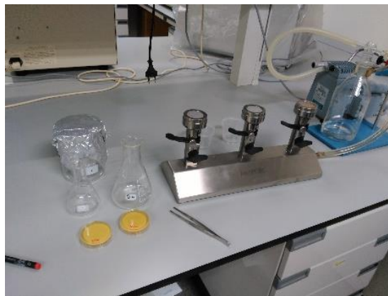
Figura 12. Equipo de filtración
