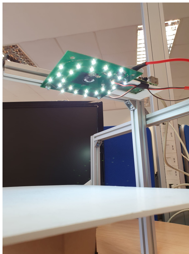
Figura 5.2: Sistema de iluminación del prototipo
