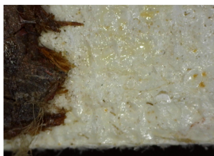
Figura 42. Capa de preparación comercial de las bandas de refuerzo. Fotografía realizada con Dino-Lite Special Lighting, x50.
