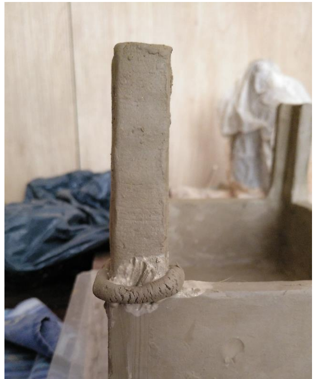
Imagen 54. Refuerzo de una pata con más arcilla
