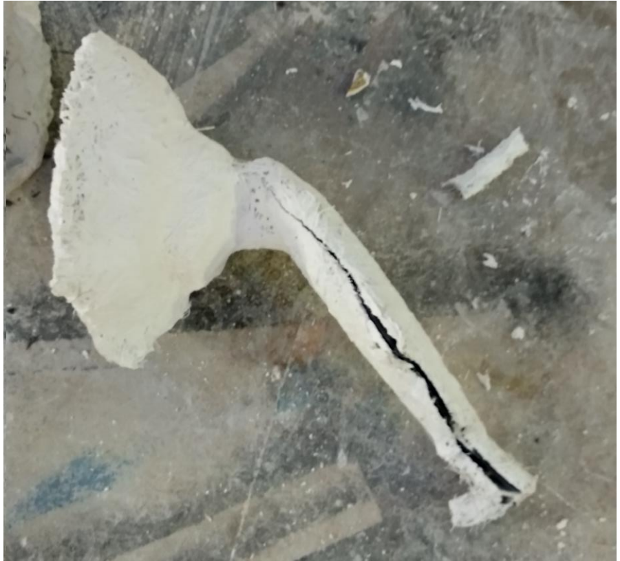
Imagen 11. Cáscara cerámica quebrándose con la contracción del metal al enfriar
