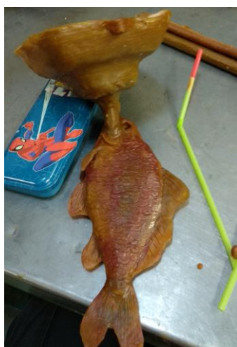
Imagen 7. Modelado en cera para cáscara cerámica
