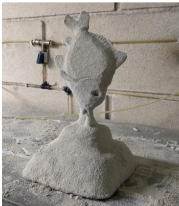
Imagen 9. Proceso de recubrimiento de cáscara cerámica.
