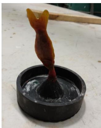
Imagen 8. Modelado cera para microfundición
