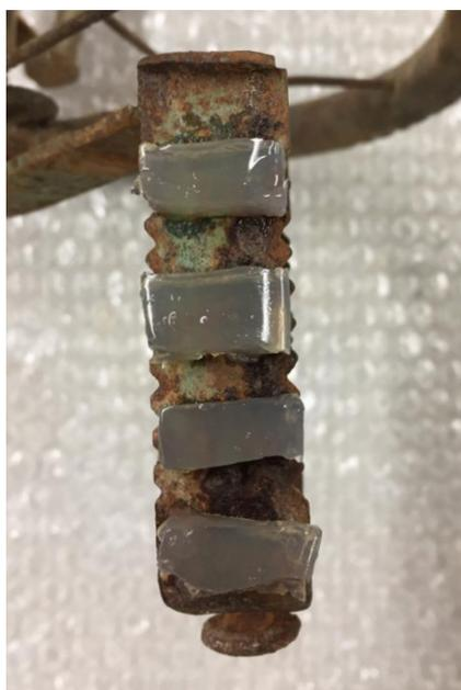
Fig. 19. Prueba con gel de agar - agar y EDTA tetrasódico.
