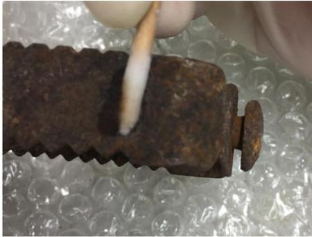
Fig. 9. Prueba de solubilidad acetona sobre el metal.
