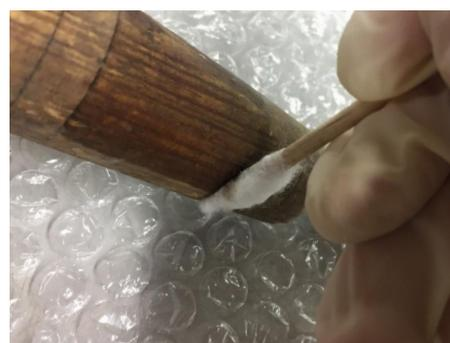
Fig. 12. Prueba solubilidad acetona sobre la madera.
