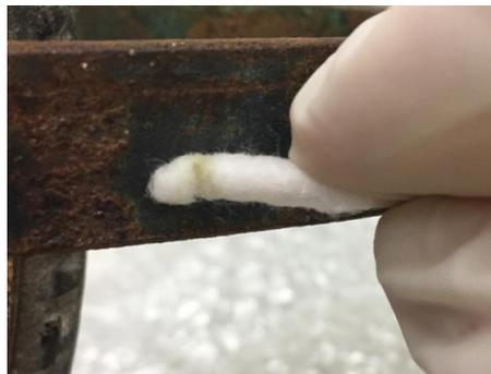
Fig. 10. Prueba de solubilidad acetona sobre pintura.
