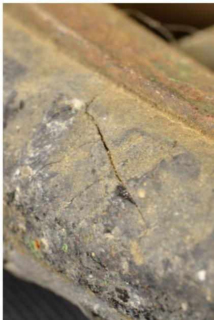
Fig.15. Neumatico craquelado y con depósitos de tierra y polvo.
