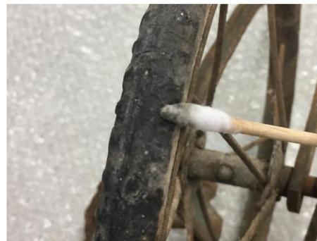
Fig. 11. Prueba solubilidad acetona sobre neumático
