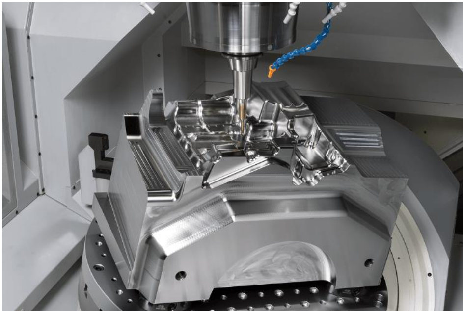
Ilustración 1. Fresado de alta precisión de una pieza.
