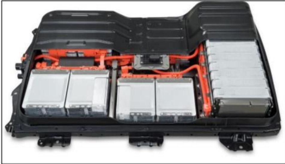
Figura 5.4: Organizaci3n de las celdas de la batera de un Nissan Leaf (vehiculo elèctrico)
