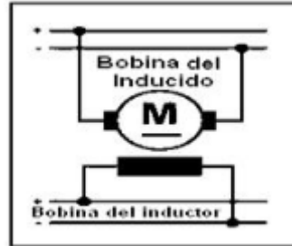
Figura 5.20: Esquema de motor CC excitaci3n en paralelo
