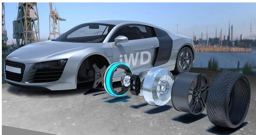
Figura 5.27: Motor de flujo axial implementado en una rueda de vehículo eléctrico
