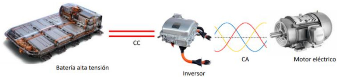
Figura 5.30: Esquema de paso de corriente eléctrica por el tren de potencia
