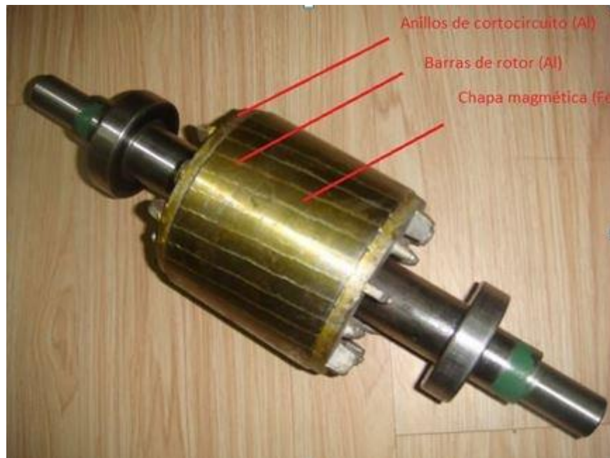
Figura 5.22: Rotor de Jaula de Ardilla
