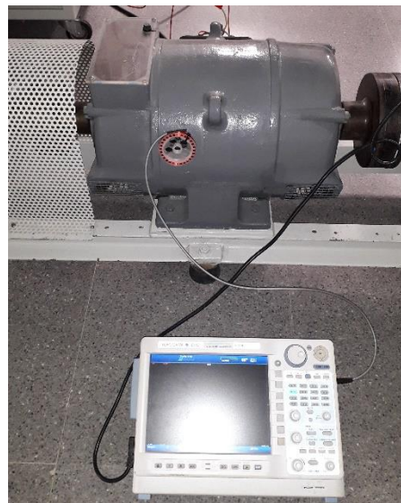
Figura 25. Montaje del sensor en la posición B sobre la carcasa de la máquina síncrona 1 (MS1).
