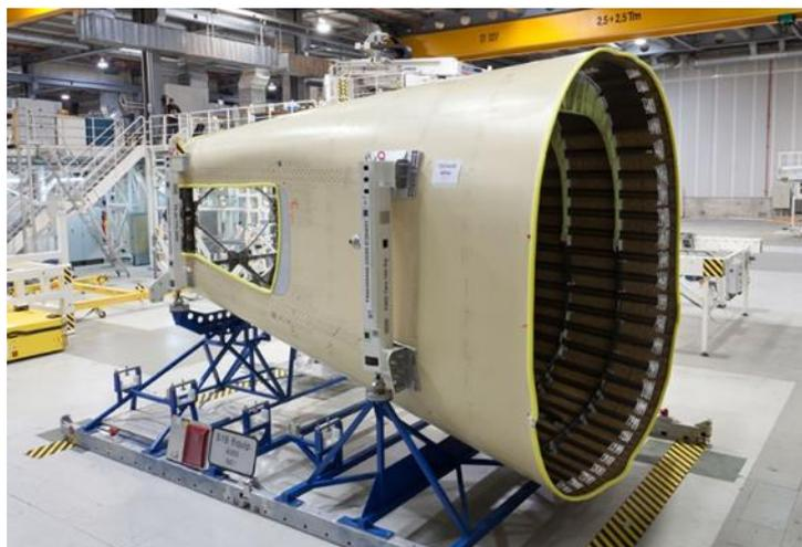
Figura 4.1: Sección 19 del fuselaje del avión A350.
