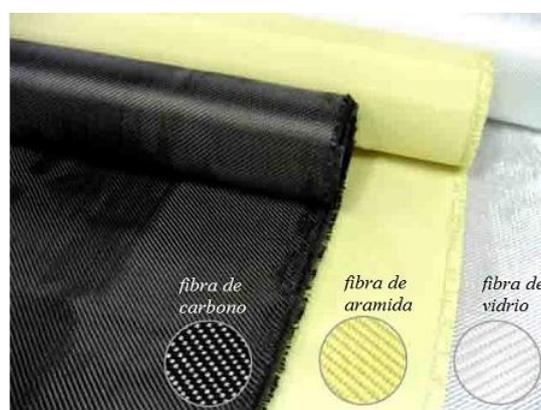
Figura 2.2: Tipos de fibra empleados en materiales FRP [3].
