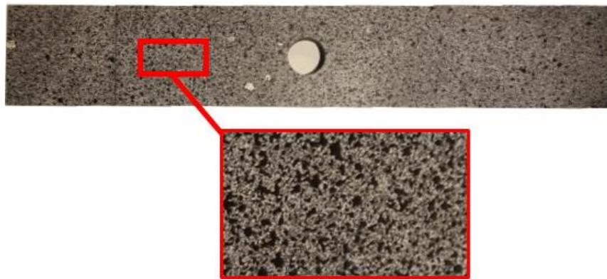
Figura 4.3: Preparación de la superficie de las probetas. Arriba probeta rectangular con agujero grande, abajo detalle de la superficie.
