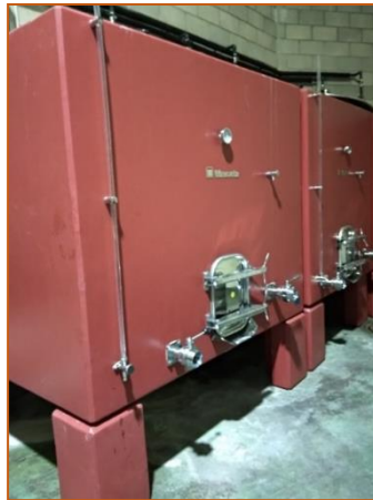
Figura 3. Depósito de hormigón usado en la vinificación.
