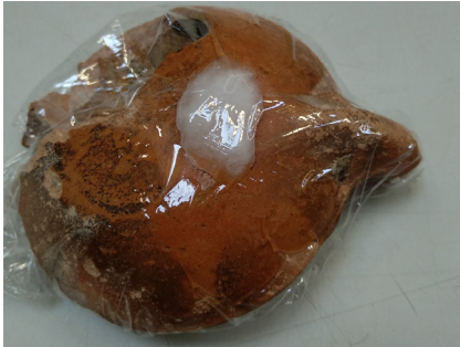
Fig. 47: Lucerna con algodón y papel film en la prueba para determinar la presencia de sales.
