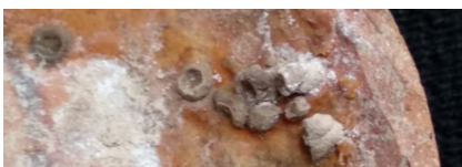
Fig. 38: Incrustaciones calcáreas y material pétreo.
