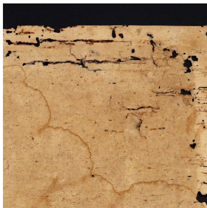
Figura 28: Detalle de las galerías ocasionadas por ataque de insectos.
