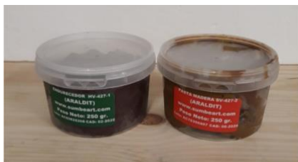
Figura 39: Masilla reparadora con su resina y catalizador Araldit® SV427 + HV427.
