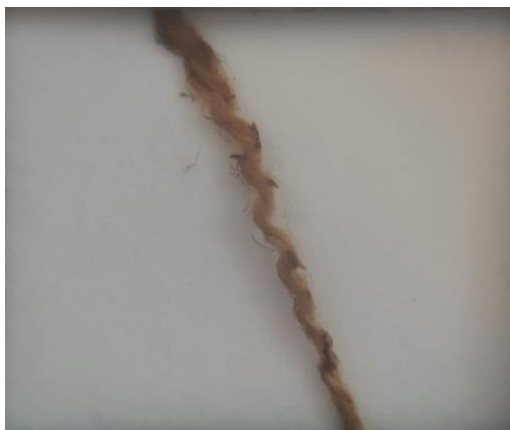
Figura 8: Detalle aumentado mediante cuentahilos de la torsión en S del hilo.
