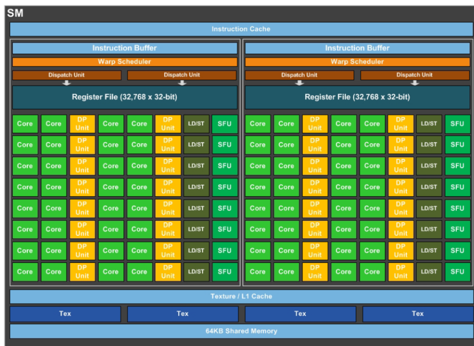
Figura 2.3: SM de la GPU Pascal GP100 [15]
