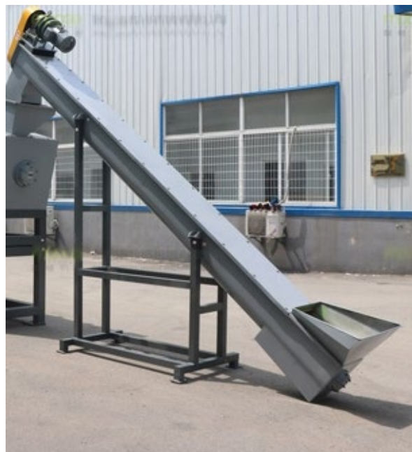
Ilustración 18 Tornillo sinfin - Fuente: Mooge Tech.
