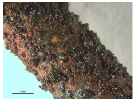
Figura 22. Goetita [ \alpha -Fe 3 O(OH)] en hierro forjado a través de lupa binocular.
