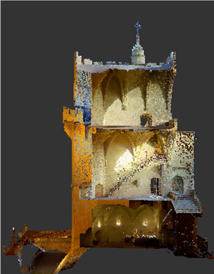
Ilustración 64: Sección de la torre Oeste en color verdadero
