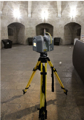
Ilustración 26: Láser escáner escaneando la recepción en la planta baja.
