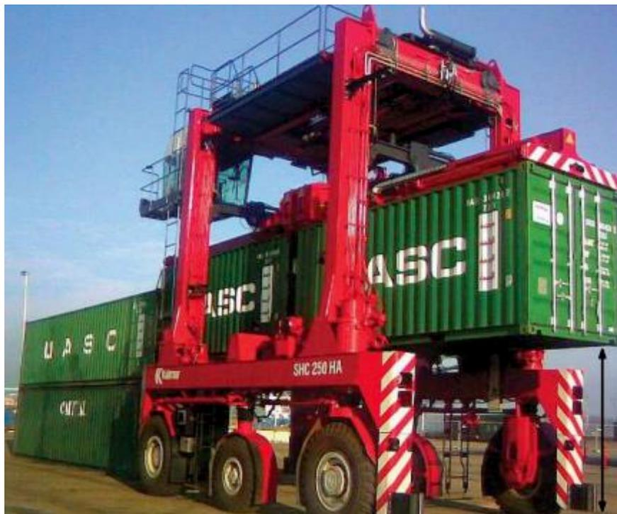
*Ilustración 13. ALV de la casa Kalmar (AShC) transportando un contenedor de 40'. Fuente: Roy and de Koster: Modeling and Design of Container Terminal*
