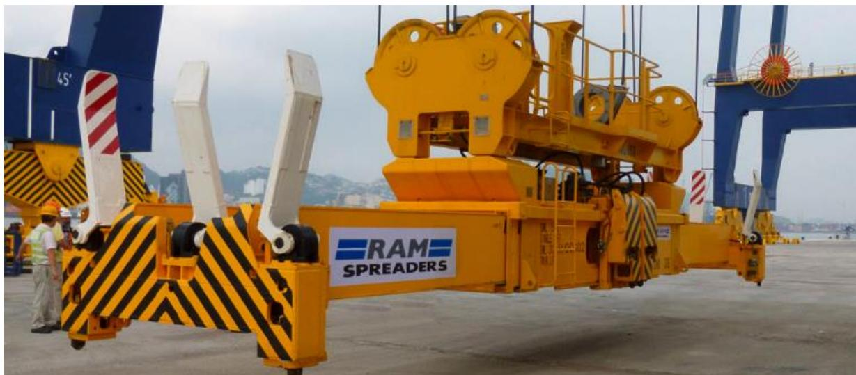
Ilustración 27. Spreader para grúa STS. Fuente: RAM spreaders
