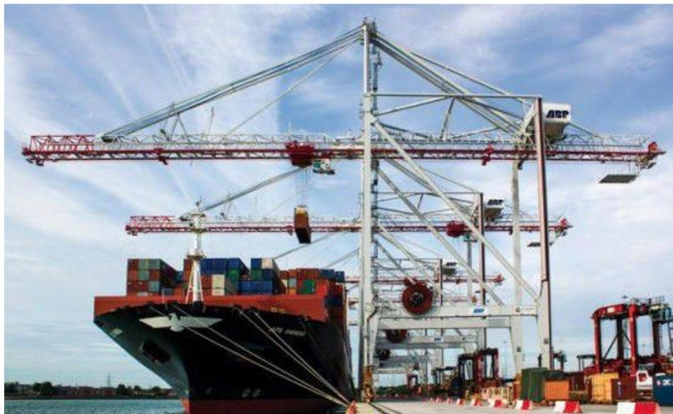
Ilustración 48. Grúas pórtico (STS) para contenedores Post-Panamax. Fuente: naticexpo
