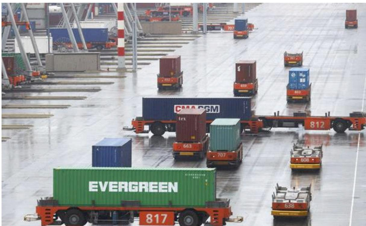
Ilustración 50. AGV y AGV-lift Fuente: nauticexpo
