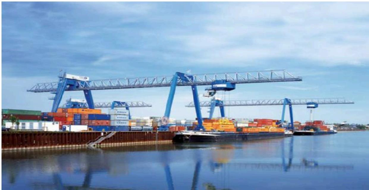
Ilustración 31. Grúa de largo alcance (WSG). Fuente: Gottwald Port technology
