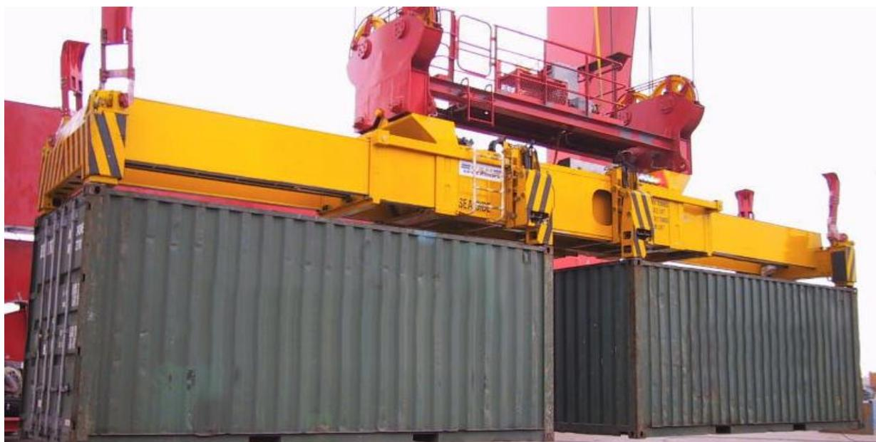
Ilustración 28. Spreader para grúa STS para manipular varios contenedores a la vez. Fuente: RAM spreaders
