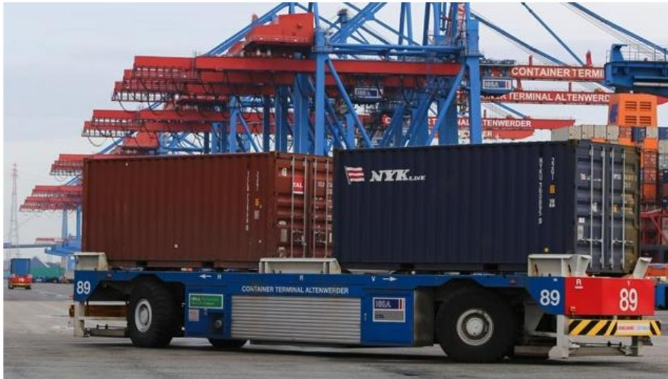
*Ilustración 12. Automated Guided Vehicles (AGVs). Fuente: konecranes*
