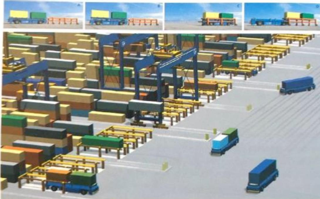
Ilustración 61. Operativa de un AGV Lift. Fuente: Manual de Capacidad Portuaria
