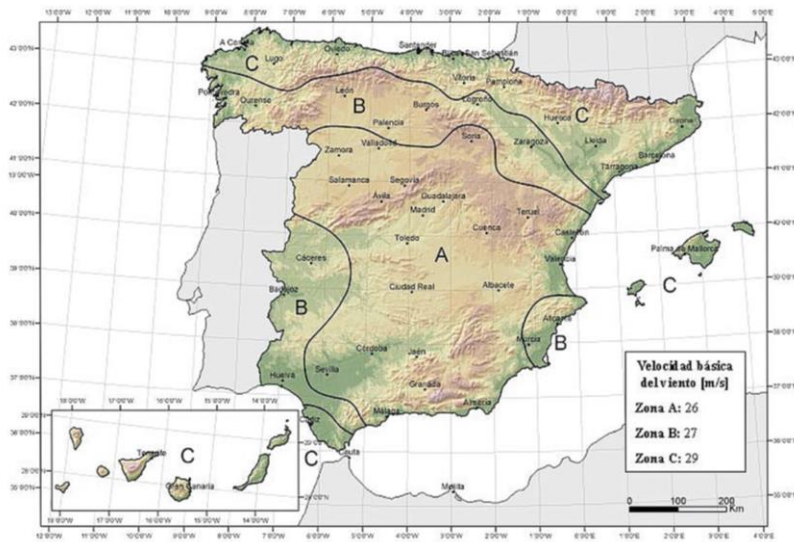
Figura 4.2-a. Mapa de isotacas para la obtención de la velocidad básica fundamental del viento. (Fuente: IAP-11, 2012).
