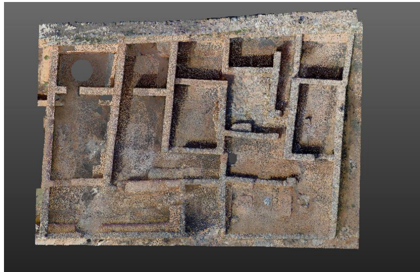
Imagen 4.11 Nube de puntos después de la segmentación II
