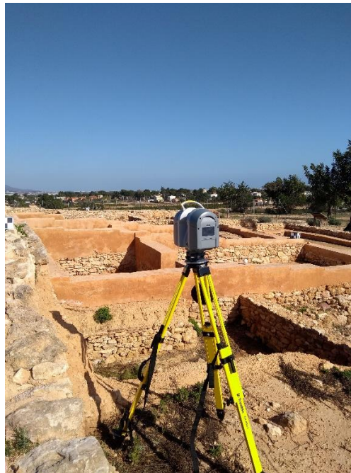
Imagen 4.2 Toma de datos con láser escáner.
