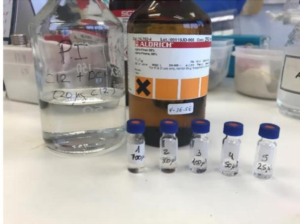
Figura 8: Elaboración de la curva patrón o de calibrado. Fuente: Elaboración propia.
