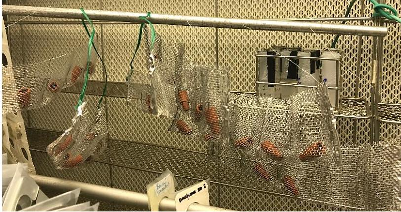
Figura 7: Cámara de aireación para el envejecimiento acelerado de los *rubber septa* de los emisores con el extracto puro de *Pinus brutia*. Fuente: Elaboración propia.
