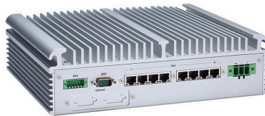
Figura 2. Interfaces de comunicación de un Box PC.
