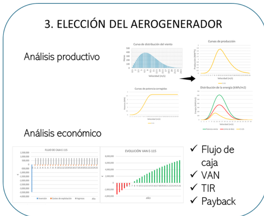
Figura 21- Bloque 3: elección del aerogenerador (Fuente: elaboración propia)
