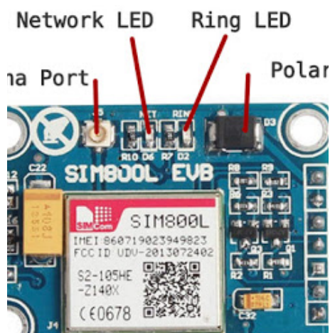
Ilustración 70. LEDs módulo GSM “SIM800L EVB”.
