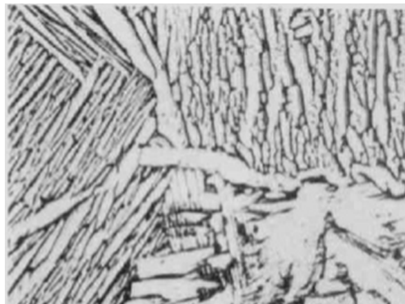
Figura 3. Microestructura laminar de Ti6Al4V. Fuente: (Rodney y Collings, 1993).
