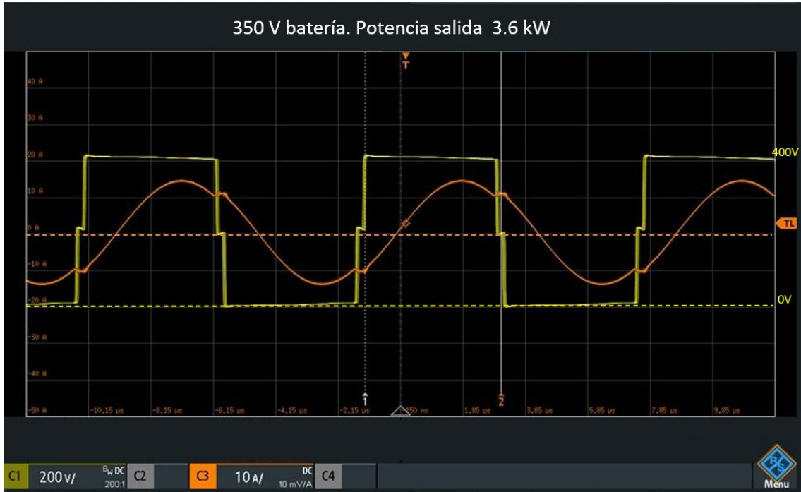
Figura 52. Osciloscopio tensión y corriente primario LLC 3.6kW, Vbat = 350V . Fuente propia
