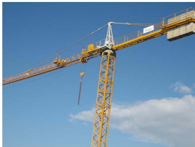
Figura 20. Cables y gancho.
