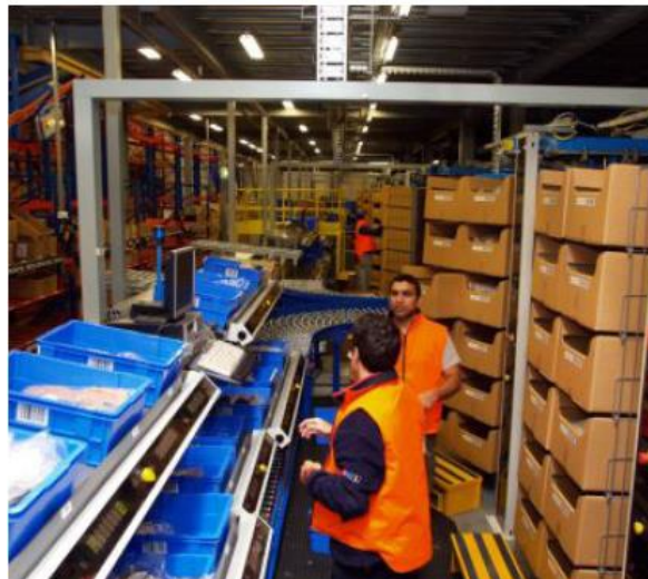
Figura 32. Batch picking en el carrusel horizontal. Fuente: Modula, s.f.
