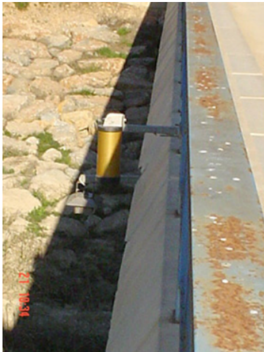
Figura 6. Sensores de nivel, sin contacto con el agua. Río Segura aguas arriba de Orihuela. Fuente CH Segura (2020)
