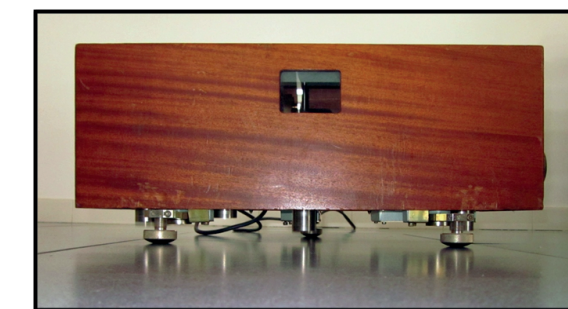
MÁQUINA DE IMPACTOS ESTANDARIZADA CREANDO RUIDO ESTACIONARIO
