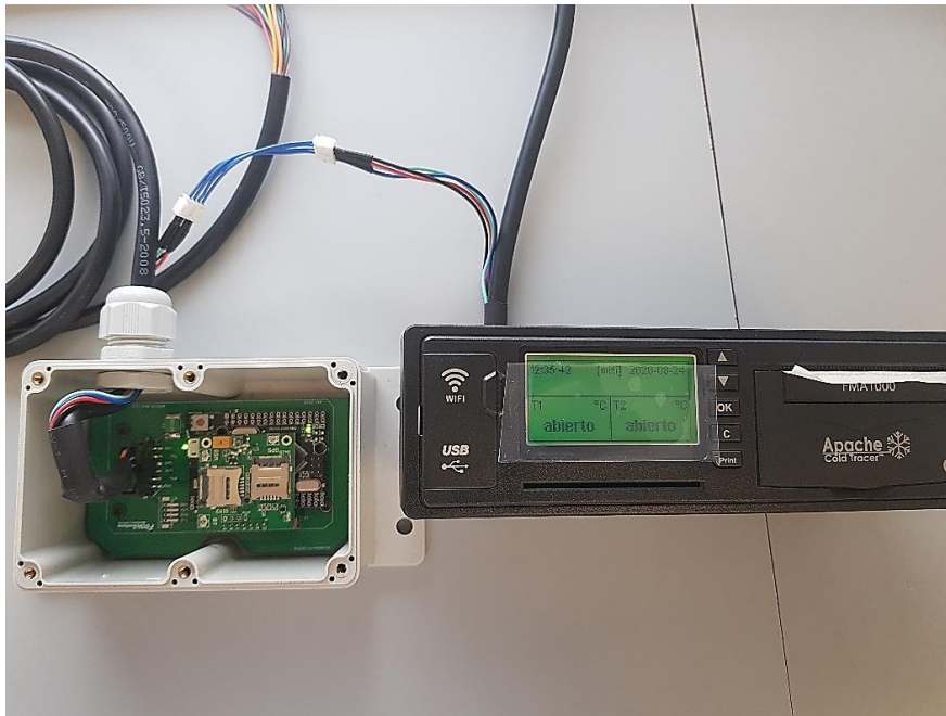
Figura 48. Conexión CAN BOX al Termógrafo Apache.
