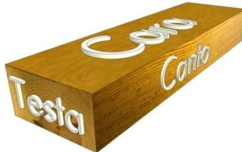
**Figura 63.** Superficies de las probetas sobre la que se apoya la antena.
