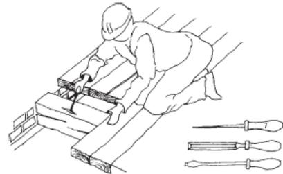
**Figura 25.** Punzón, formón y destornillador para detectar la profundidad del ataque y descubrir las galerías. (Arriaga, 2002)
