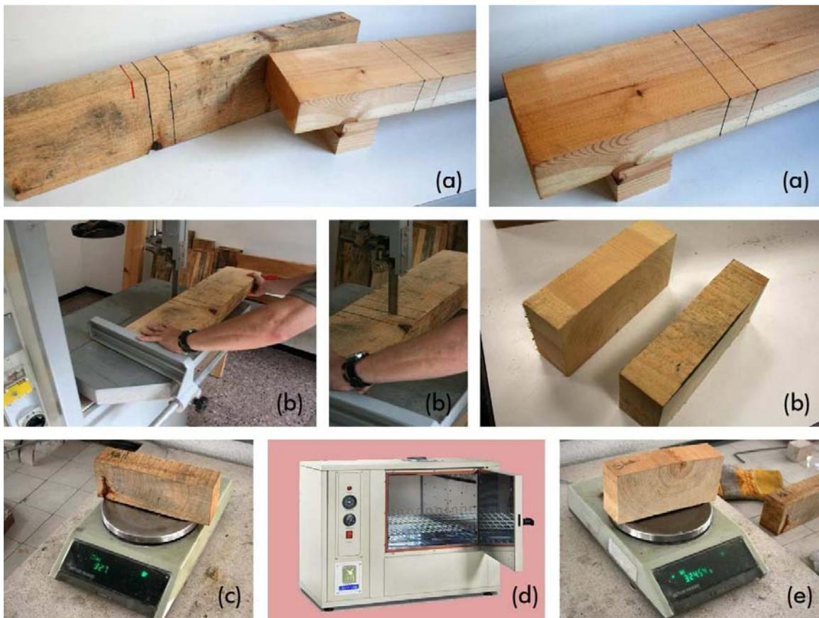
**Figura 58.** (a) marcado de las futuras probetas en una de las vigas objeto de nuestro estudio. (b) Cortado de las probetas mediante sierra. (c) pesado inicial de las probetas recién cortadas. (d) Colocación en estufa a 100°C durante 24 h. (e) Pesado de las probetas después de 24 h.
