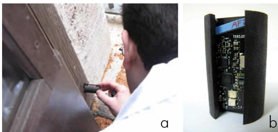
**Figura 13:** (a) Instalación del sensor. (b) Sensor CADIX® (<http://www.aidima.es/>)
