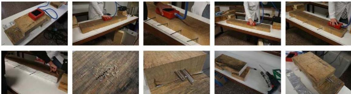
Figura 100. Ensayos con georradar.
