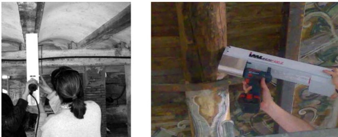
**Figura 17.** Utilización de resistógrafo para inspección de estructuras antiguas
