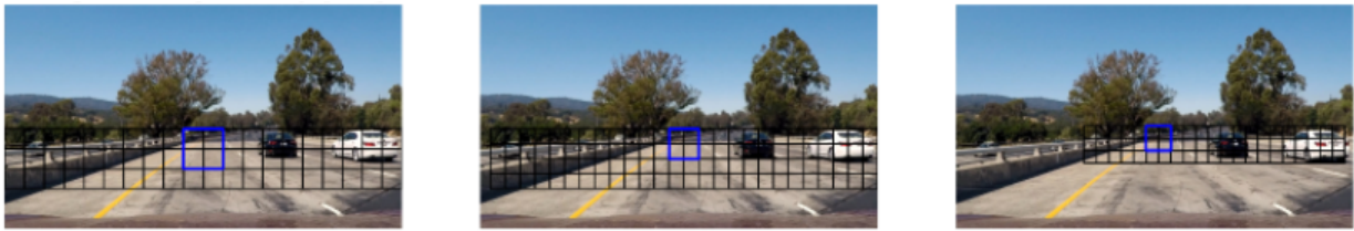
Figura 17: Creación de un algoritmo de sliding window [25]
