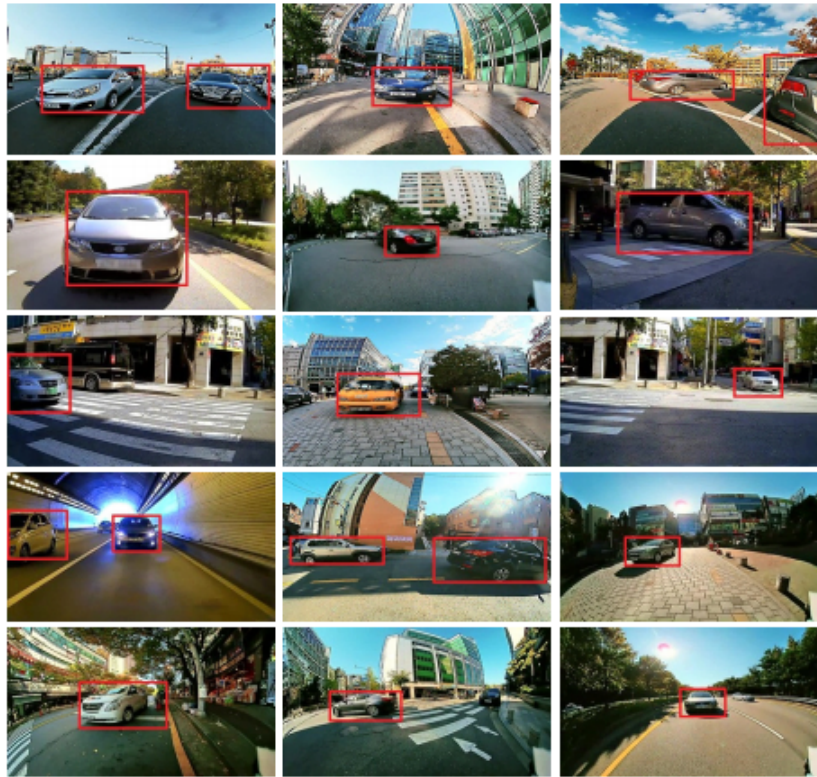
Figura 6: Resultados de la detección utilizando la sustracción de fondo dinámico [14]
