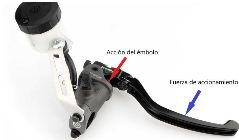
Figura 13. Bomba radial delantera de una motocicleta.
