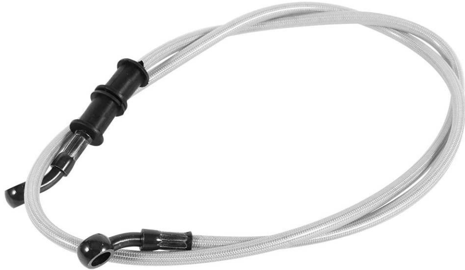
Figura 16. Latiguillo de freno metálico.
