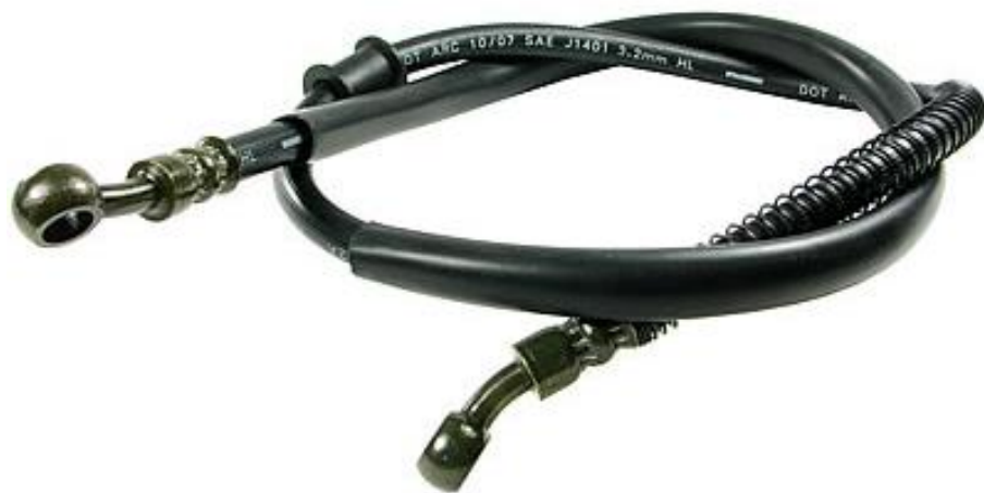
Figura 15. Latiguillo de freno de goma rígida.
