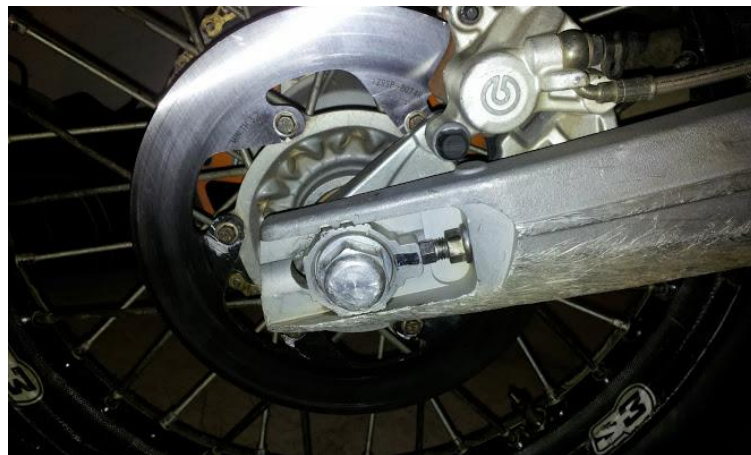
Figura 26. Disco liso de anclaje fijo.
