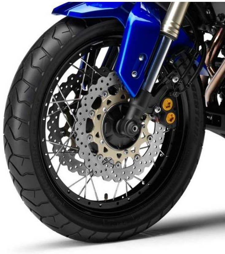
Figura 27. Disco perforado y lobulado de anclaje flotante.
