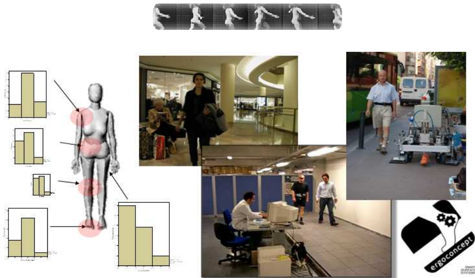
Figura 12. Colección de imágenes que representan la recreación en laboratorio de la deambulación en los espacios públicos. En la imagen de laboratorio se aprecia como la plataforma de fuerzas queda integrada en la instalación y por tanto no influye en el patrón de marcha natural de los sujetos de ensayo. Fuente IBV.
