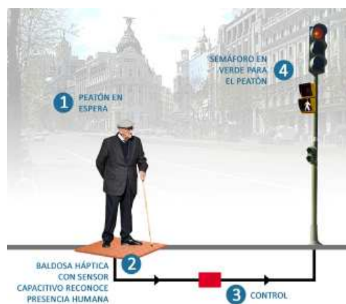
Figura 39. Esquema de funcionamiento, en 4 fases, del vado peatonal cerámico inteligente.
