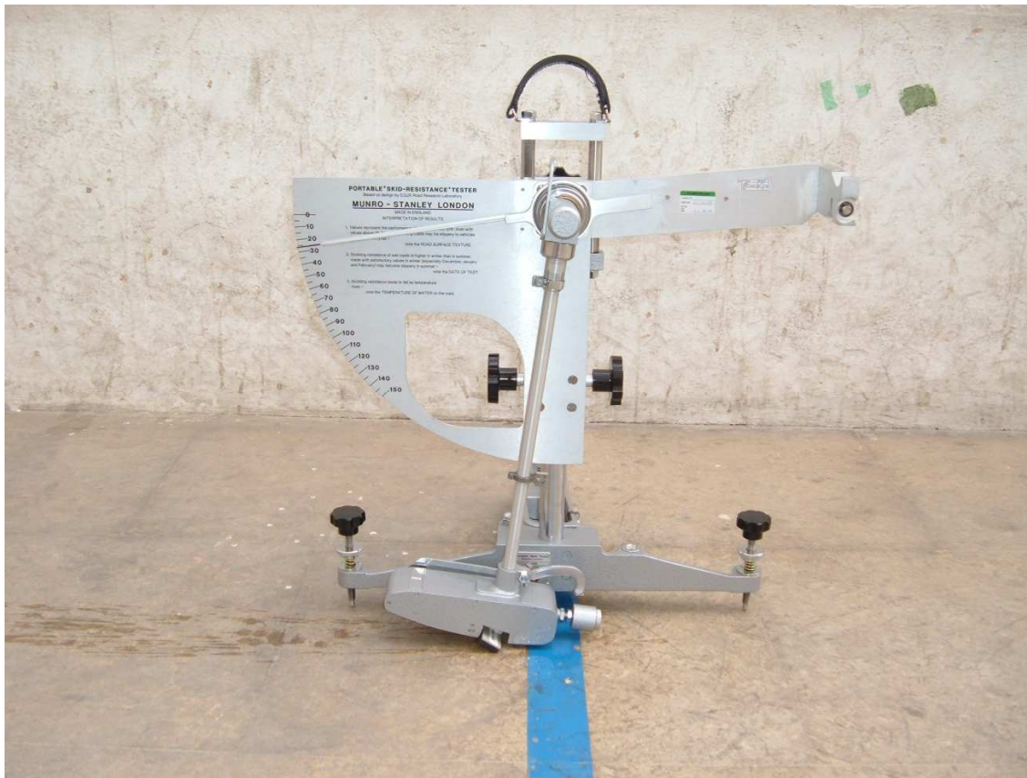
Figura 37. Instrumento de medida de la fricción conocido como péndulo TRRL.
