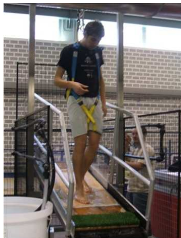
Figura 34. Rampa de inclinación variable con usuarios descalzos (EN 13451-1)
