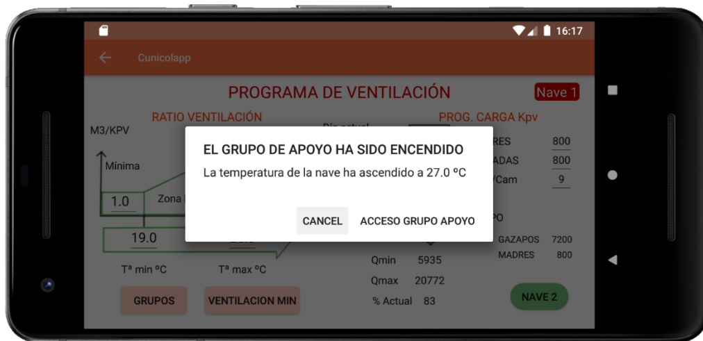
Figura 22: Ventana de ventilación. Alarma grupo de apoyo.
