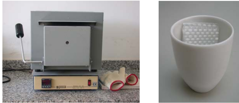
Figura IV.20. Horno de calcinación y material compuesto tras el ensayo.
