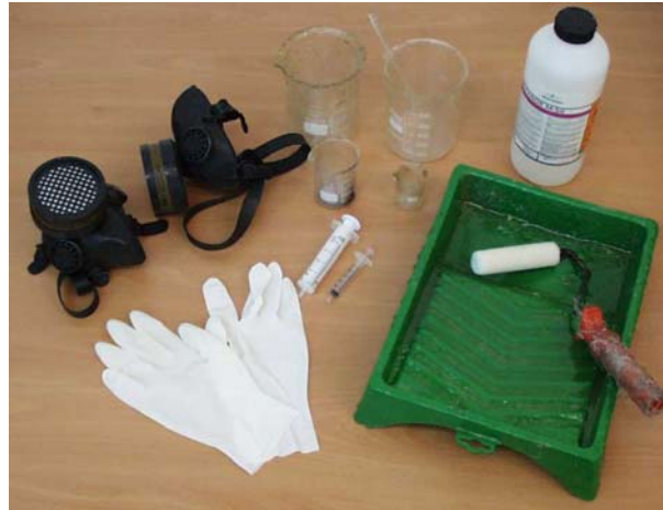
Figura IV.4. Material necesario para la elaboración de los laminados de material compuesto.
