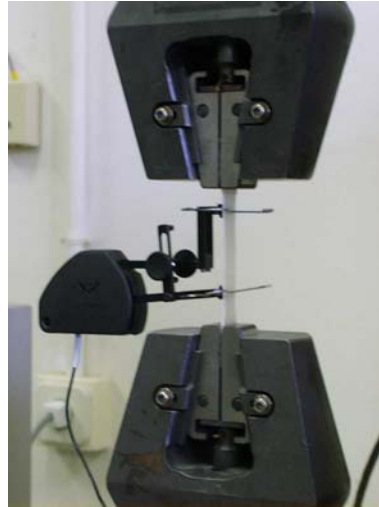
Figura IV.12. Detalle probeta con extensómetro durante ensayo de tracción.
