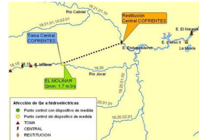
Figura 14. Situación de la Central de Cofrentes y su toma en el embalse del Molinar. Fuente: Confederación Hidrográfica del Júcar
