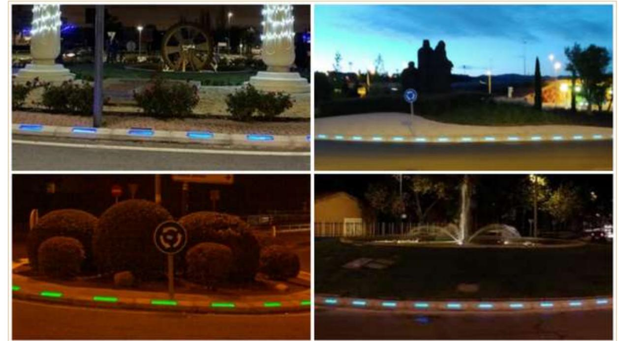
**Figura 83:** Funcionamiento de bordillo luminoso para glorietas.
