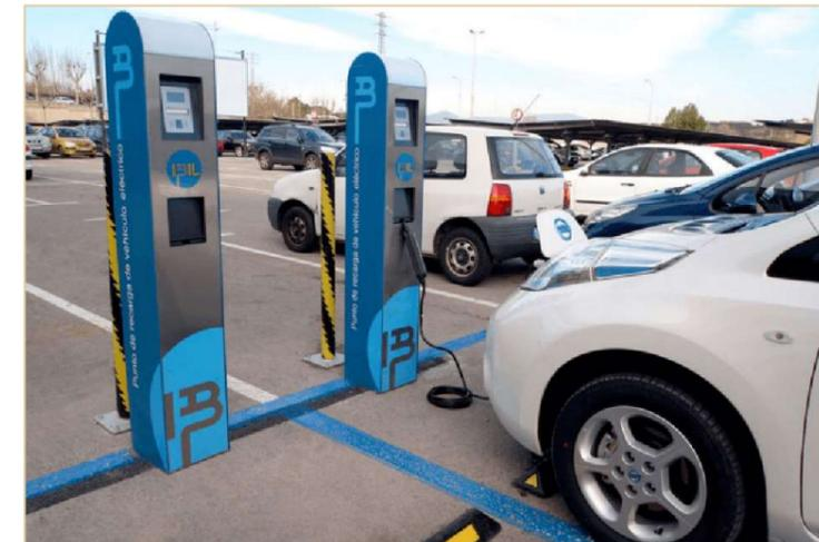
Figura 163: Punto de recarga de vehículo eléctrico.
