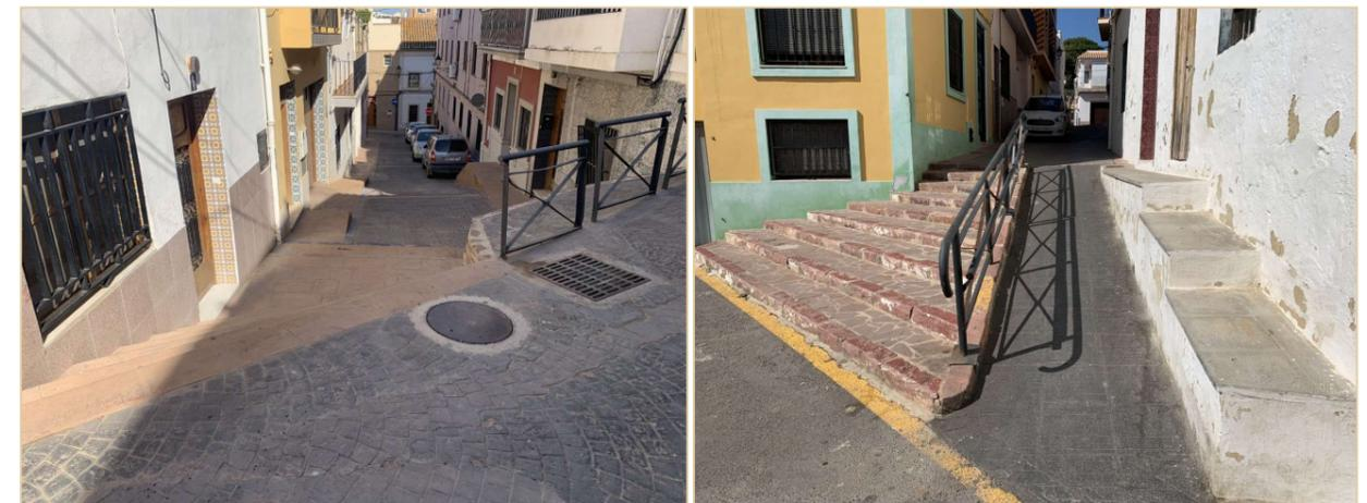
Figuras 59 y 60: Comparación entre barrera arquitectónica y rampa rehabilitada.
