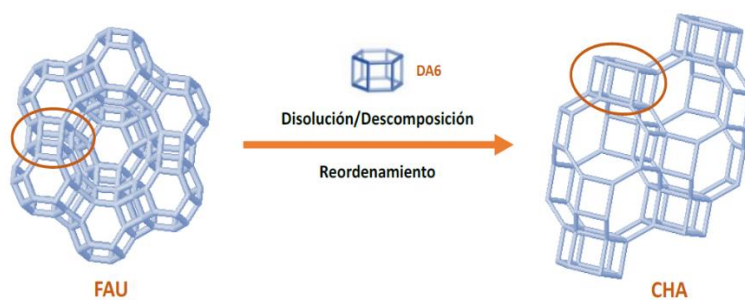
Figura 38- Esquema del proceso de descomposición/disolución de la zeolita precursora (FAU) en fragmentos estructurales y reordenamiento de los mismos para generar una nueva estructura (CHA).
