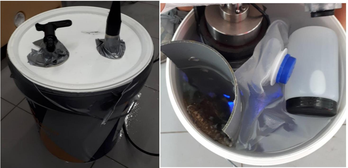
*Figura 7: Cubo donde se midió la respiración de las nacras en cada temperatura. A la izquierda: el cubo una vez listo para medir, se colocó cinta americana para mejorar la estanqueidad y usó el grifo para llenar de agua el cubo por completo. A la derecha: el cubo por dentro, se puede observar la nacra y el plástico para protegerla, así como la sonda y los diversos recipientes para disminuir el volumen.*
