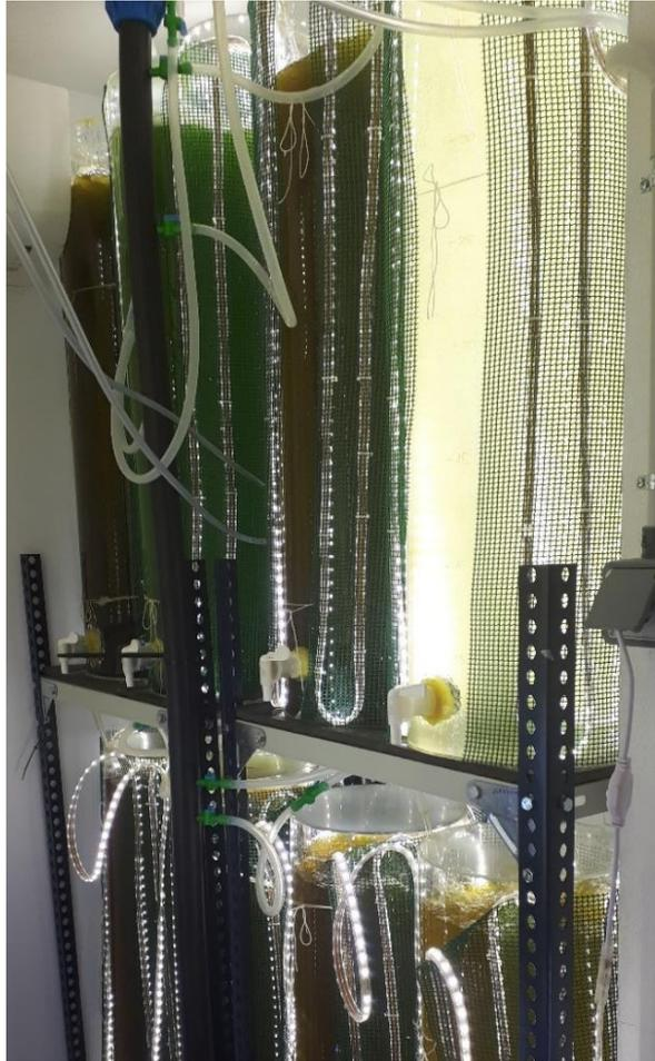
*Figura 2: Tubos de fitoplancton. El color indica la concentración de fitoplancton que tiene y cuando fue inoculado, aproximadamente. Se puede observar las camisas de malla de plástico fabricadas para enfocar la luz y que incide con mayor eficacia sobre la columna de agua.*
