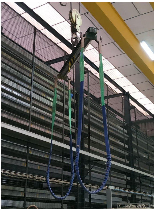
Ilustración 6: Eslingas de 2T con funda Fuente propia
