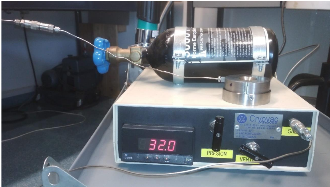
Figura 4. Bomba de presión conectada a la DAC mediante un tubo capilar que conecta la bomba y una membrana hinchable en la carcasa que aloja al pistón de la DAC.
