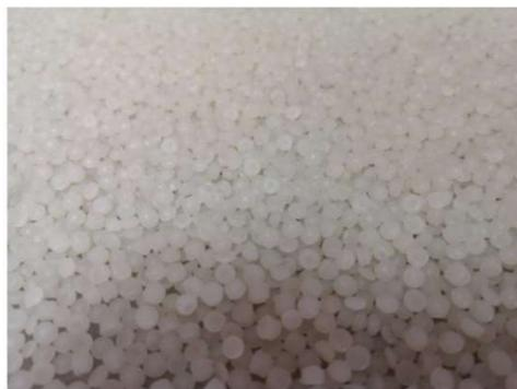
Ilustración 46. Polietileno de alta densidad reciclado. Fuente: Airesa
